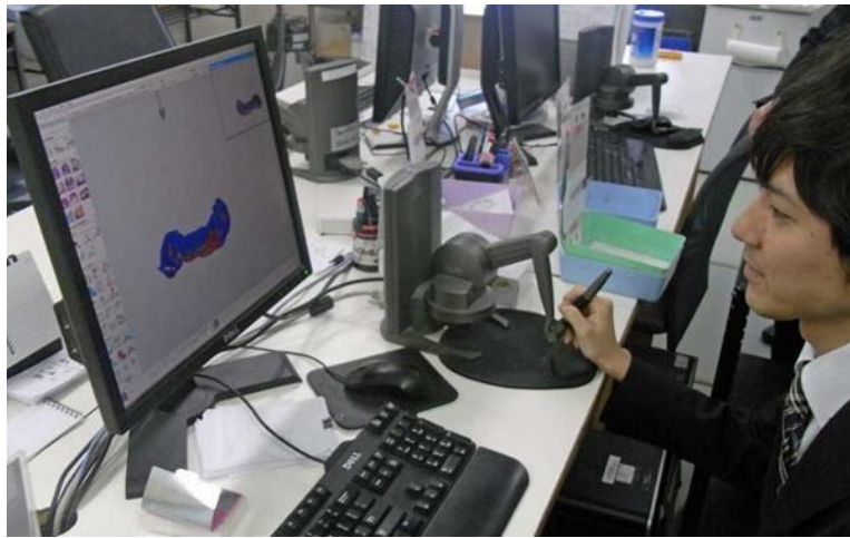
牙技師根據掃描出的齒模數據，在計算機上設計假牙(註三)
