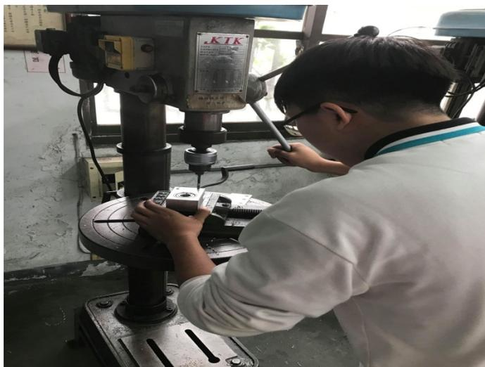
圖十鑽削螺紋孔（研究者製作）
