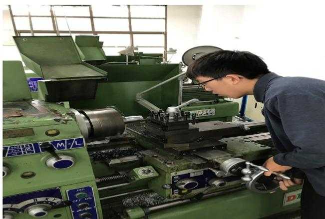
圖八擺錘的車削（研究者製作）
