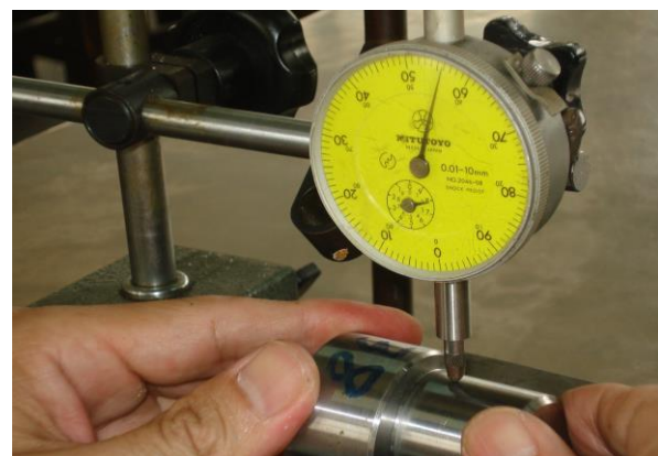
說明：2mm 偏心的測量(量錶轉 4 圈)
