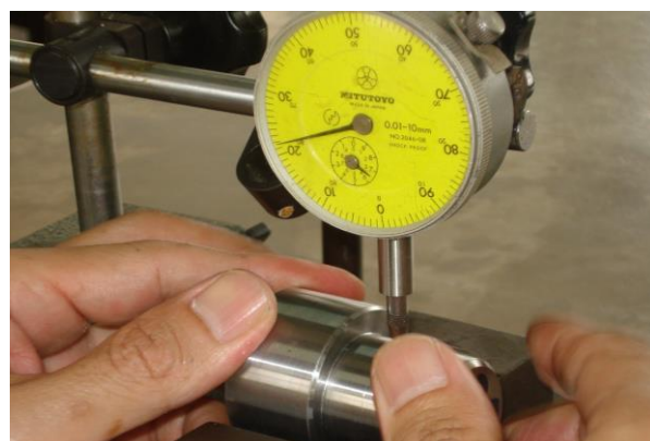
說明：2mm 偏心的車削過程
