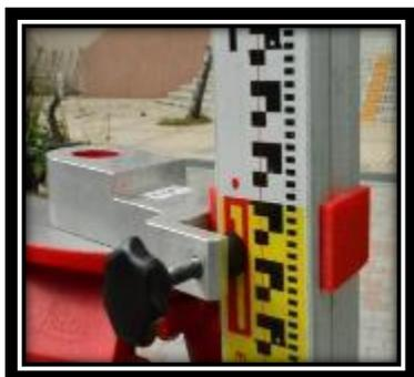
圖八 尺夾套入水準尺
