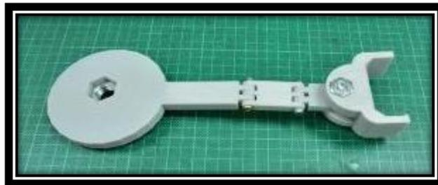
圖二十 利用 3D 列印機列印出尺夾成品，並將其以螺絲組合而成
