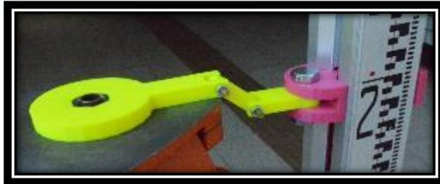
圖十八 將尺夾套入水準尺，比對比例是否有錯誤
